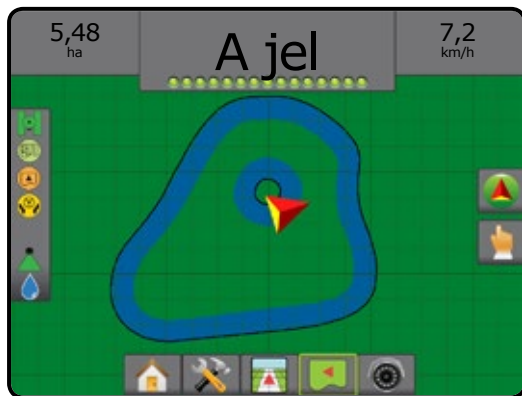
6-27 ábra: Belső határvonal hozzáadása
