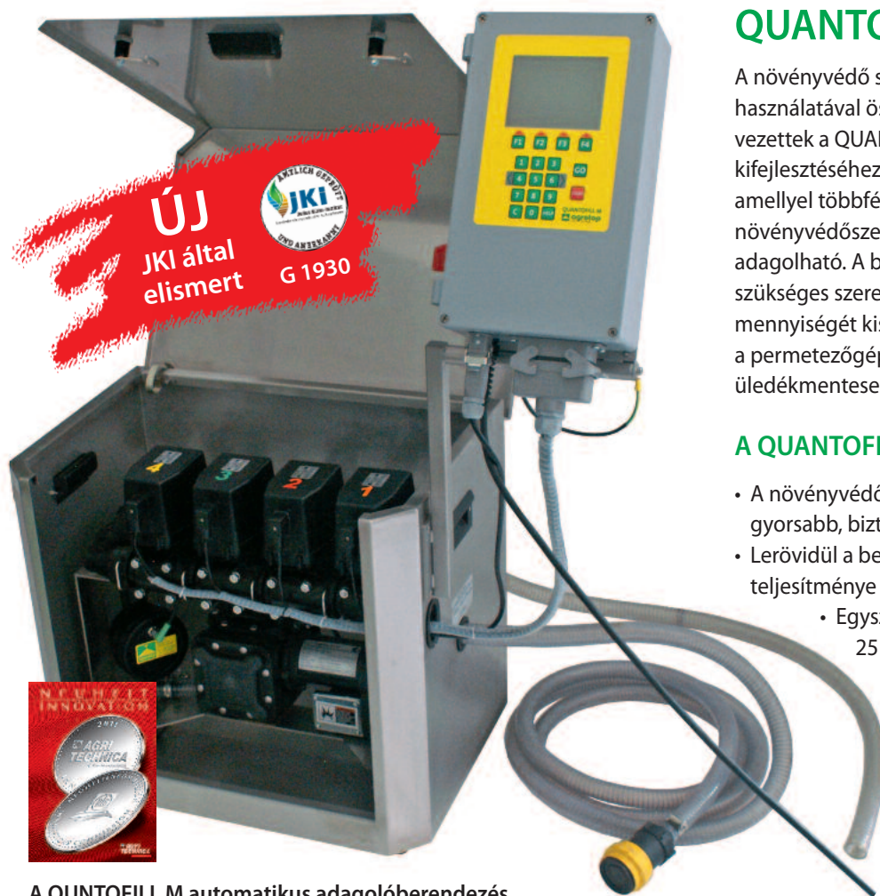
A QUANTOFILL M automatikus adagolóberendezés négy vagy öt szeradagolóval szállítható. További információk, műszaki adatok igény szerint.
