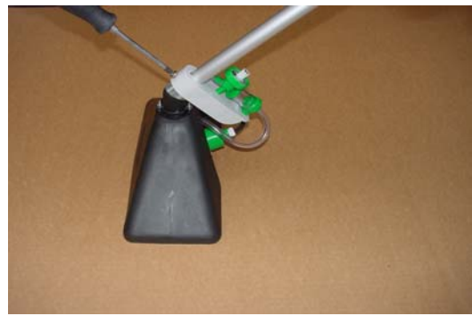
2. Az átfolyás-ellenőrzőt a védőernyővel és annak tartójával csavarozzuk össze
